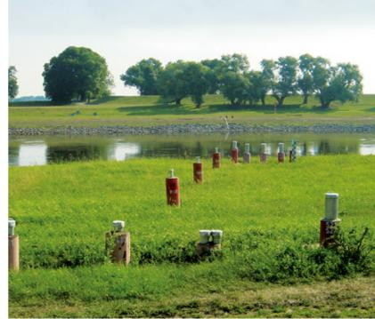
**«** Die Qualität des Grundwassers wird über Gütemessstellen an der Elbe sowie im Hinterland erfasst.
